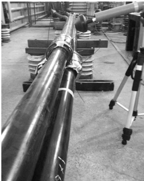
Рис. 5. Кабельная линия, проложенная «треугольником встык»
