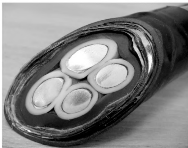
Рис. 8. Общий вид магнитного экрана для силового кабеля
