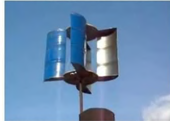
Работающий ветряк "чашечного" типа КПД использования ветровой энергии не превышает 10-12%
