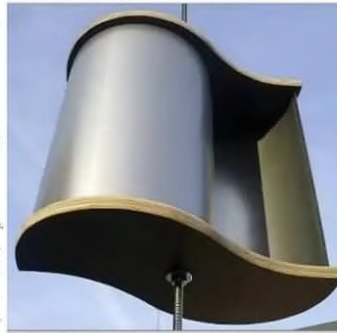
Ротор Савониуса с перекрытием лопастей и усиленной тягой. КПД использования ветровой энергии достигает 18-20%
